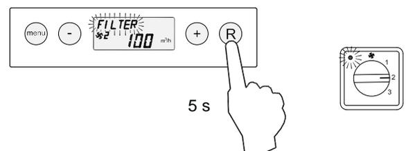
Dopo il resettaggio del filtro, il messaggio "FILTER" scompare; la spia del selettore si spegne e il display torna nella modalità normale di funzionamento.
