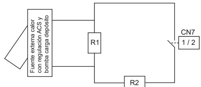
$R1$  Sonda del depósito de la fuente de calor
