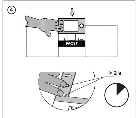
Pulsar las teclas por lo menos durante 2 segundos (carcasa de control del generador de calor) conectar la unidad.
