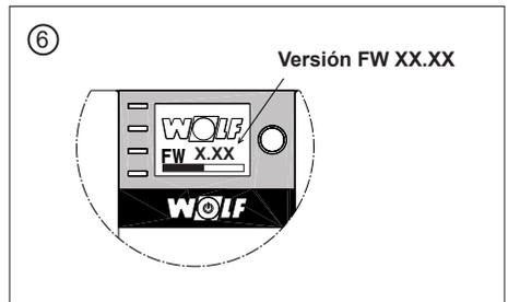
Finalizado el proceso de carga, se muestra la versión actual del software. La BM-2 se reinicia automáticamente después de completarse la actualización.
