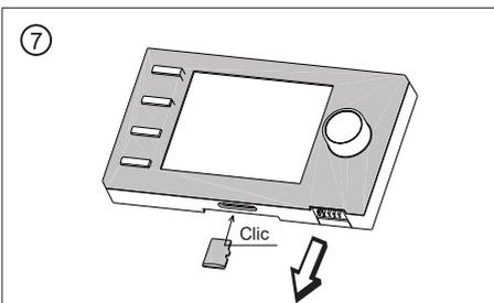
El equipo vuelve a estar plenamente operativo. La tarjeta Micro SD se puede extraer y utilizar más adelante.
