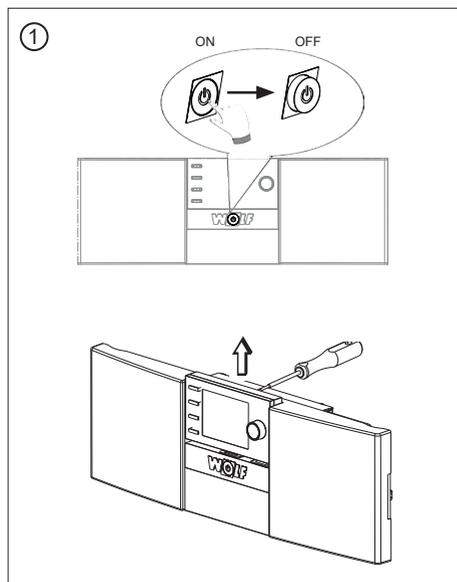
Desconectar el interruptor principal y extraer la BM-2 de la carcasa de la regulación o del zócalo de pared.
