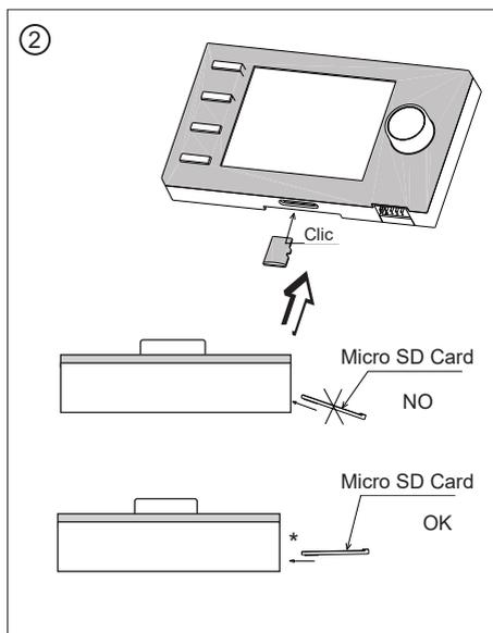
Insertar una tarjeta Micro SD en la ranura de la BM-2.
