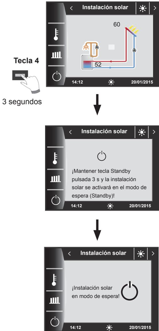
En la pantalla de estado Instalación solar se puede cambiar al modo de espera pulsando la tecla 4 durante 3 segundos.
