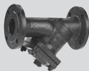
Versione con sede a flangia/inclinata con filtro in acciaio inox integrato, filtro fine (maglia da 0,25 a 0,5 mm) con vite di scarico, protezione anticorrosione mediante verniciatura a polvere, per posizione di montaggio orizzontale o verticale.
