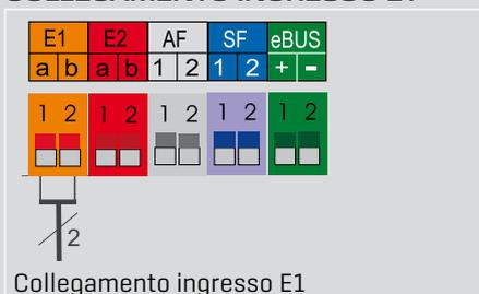
Inserire il cavo di collegamento nel pressacavo e fissarlo. Collegare il cavo dell'ingresso 1 sui morsetti E1 secondo lo schema elettrico dopo aver tolto il ponticello tra 1 e 2.
